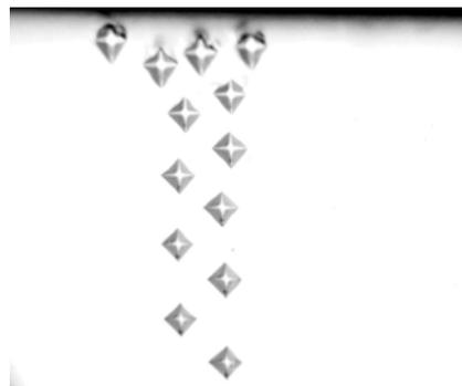
Рис. 5. Отпечатки индентора у поверхности трения стали AISI 304.
