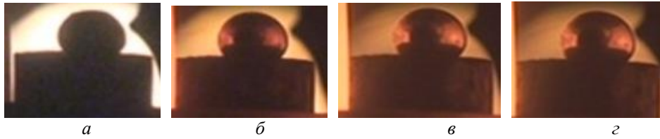
Рис. 5. Крапля розплаву індію на поверхні підкладки \text{In}_2\text{O}_3 за різних температур (К): a — 493; б — 673; в — 723; г — 773.
