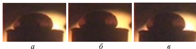
Рис. 4. Крапля розплаву галію на поверхні підкладки \text{In}_2\text{O}_3 за температур 573 (а), 623 (б) та 673 К (в).
