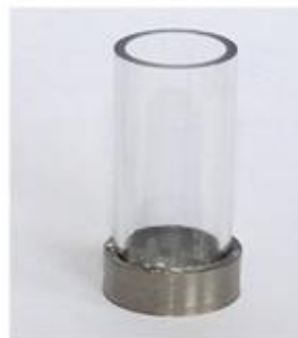
Рис. 4. Паяне з'єднання лейкосапфірового диска зі скляною трубкою: a — схема; б — паяний зразок; 1 — опорне металеве кільце; 2 — кільце з титанової фольги; 3 — лейкосапфіровий диск; 4 — припій; 5 — склотрубка; h — висота кільця з титанової фольги, що спаяна зі скляною трубкою.
