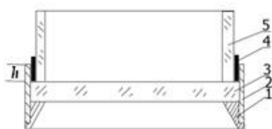
Рис. 4. Паяне з'єднання лейкосапфірового диска зі скляною трубкою: a — схема; б — паяний зразок; 1 — опорне металеве кільце; 2 — кільце з титанової фольги; 3 — лейкосапфіровий диск; 4 — припій; 5 — склотрубка; h — висота кільця з титанової фольги, що спаяна зі скляною трубкою.
