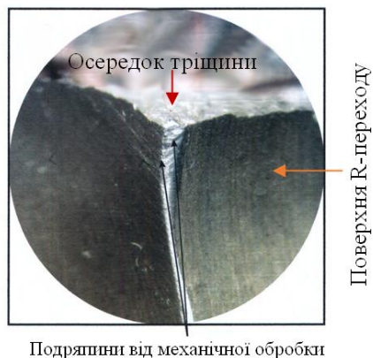
Рис. 4. Риски на поверхні округлення кромки штоку № 3 в осередку тріщини.
