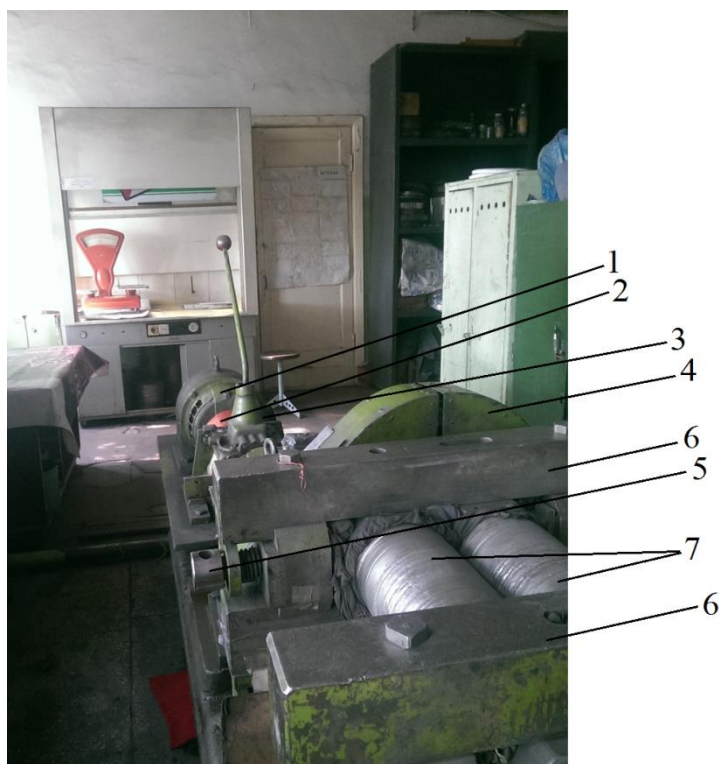
Рис 1. Модернізований коландровий стан з валками діаметром 180 мм, який використовували для обробки порошку: 1 — мотор; 2 — запобіжна муфта; 3 — механізм перемикання швидкостей (коробка швидкостей); 4 — система шестерен; 5 — натискний механізм (переміщує лівий валок у горизонтальному напрямку); 6 — розбірна станина; 7 — вальці.
