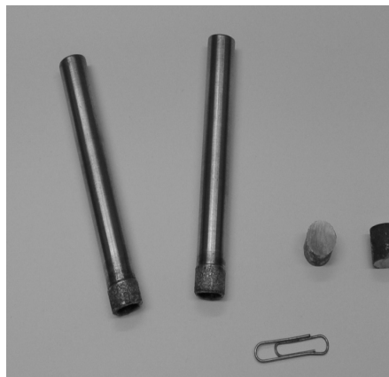
Рис. 1. Алмазні трубчасті свердла і зразки зв'язки цих інструментів.
