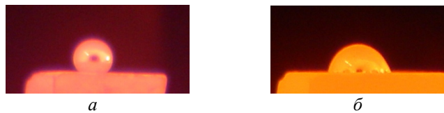
Рис. 8. Краплі розплавів галію на поверхні підкладки оксиду цинку при температурах 773 (а) та 1173 К (б).
