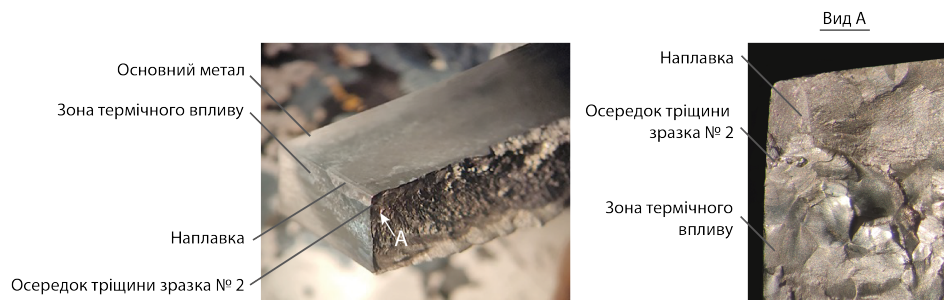
Рис. 6. Фотографія фрагменту зламу зразка № 2.
