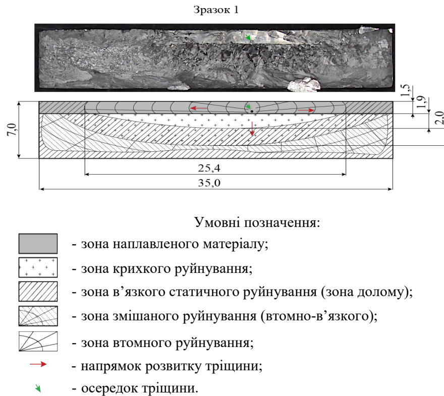
Рис. 5. Фотографія та схема будови зламу зразка № 1.
