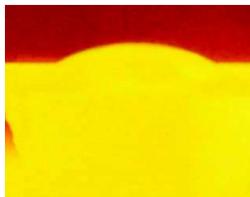
Рис. 3. Крапля міді на поверхні ZnO-кераміки (1100 °С, вакуум, 30 хв).
