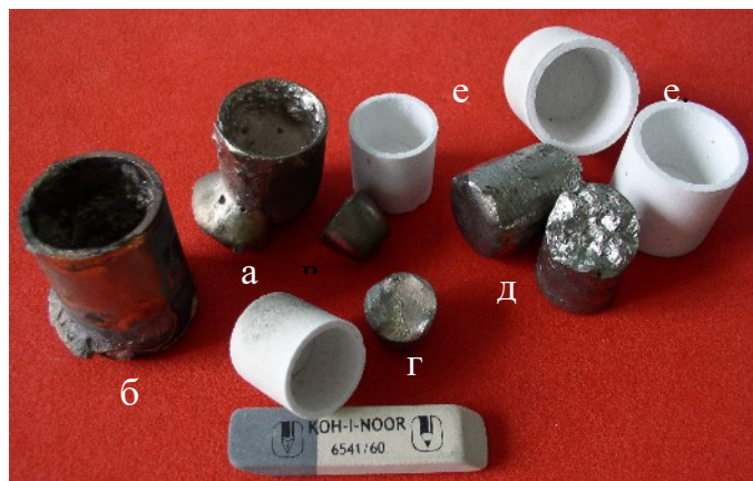
Рис. 1. Зразки хімічно агресивних сплавів Cu—Ti після плавлення при 1473 К в тиглях з матеріалів: a — \text{Al}_2\text{O}_3 ; б — графіт; в, д — сплави з великим вмістом титану (>50% (мас.)); е — фторидні тиглі.
