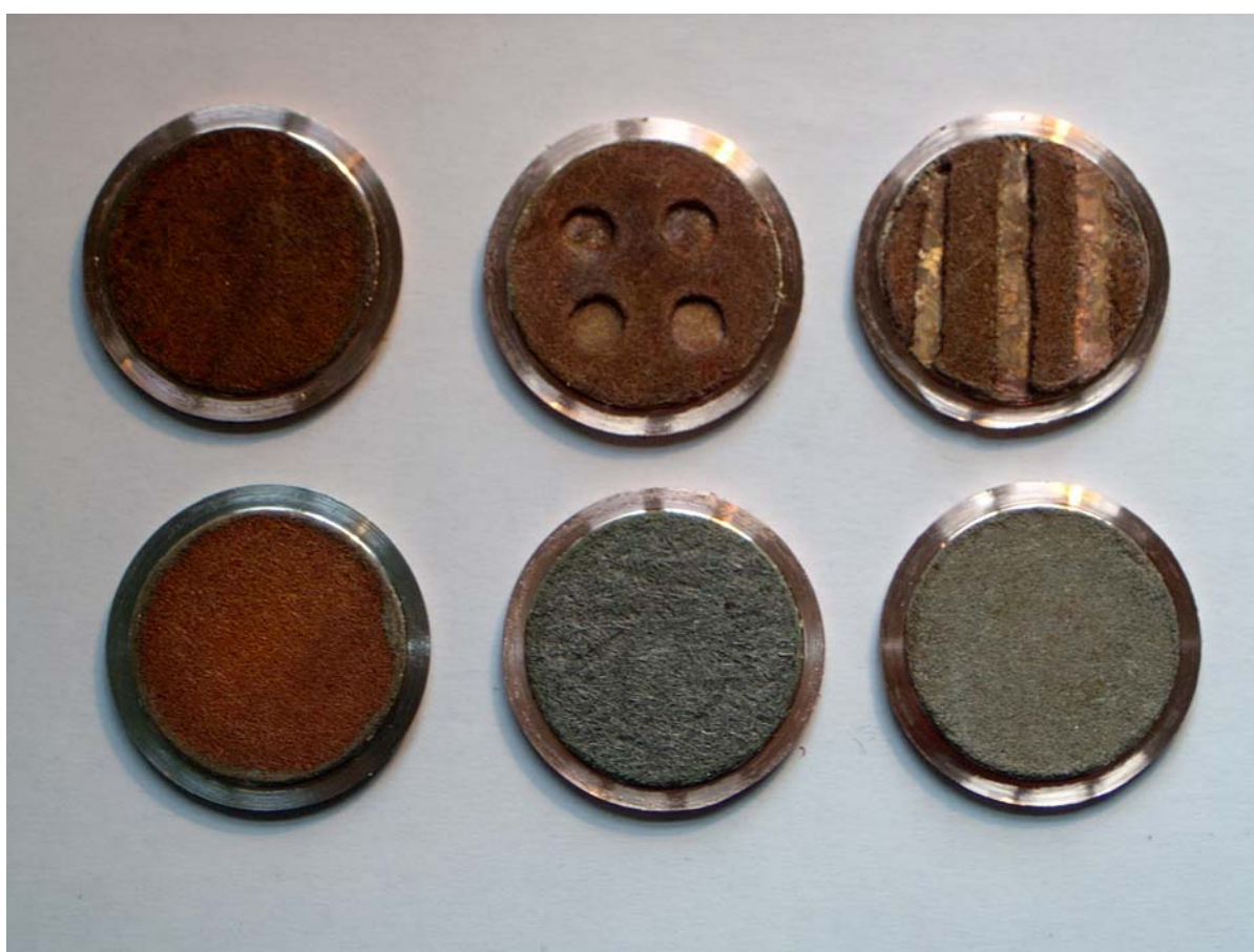
Рисунок 2.2.4 – Образцы «градиентных» металловолоконных капиллярных структур с переменной (по площади теплообменной поверхности) пористостью
