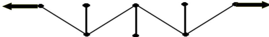
Рис. 11. Фрагмент фрактальной структуры с отрицательным коэффициентом Пуассона.
