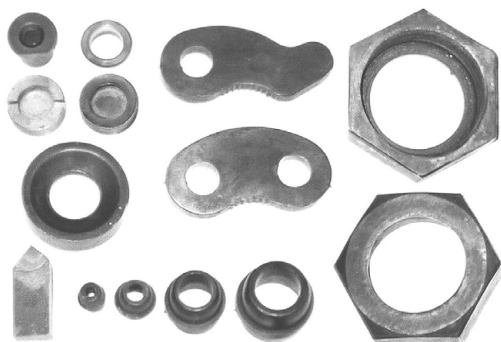
Рис. 3. Детали из гетерогенных порошковых материалов на основе железа
