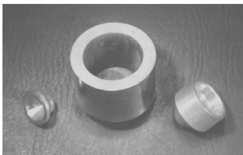
Рис. 2. Детали из медного порошка, полученного из отходов проводников тока
