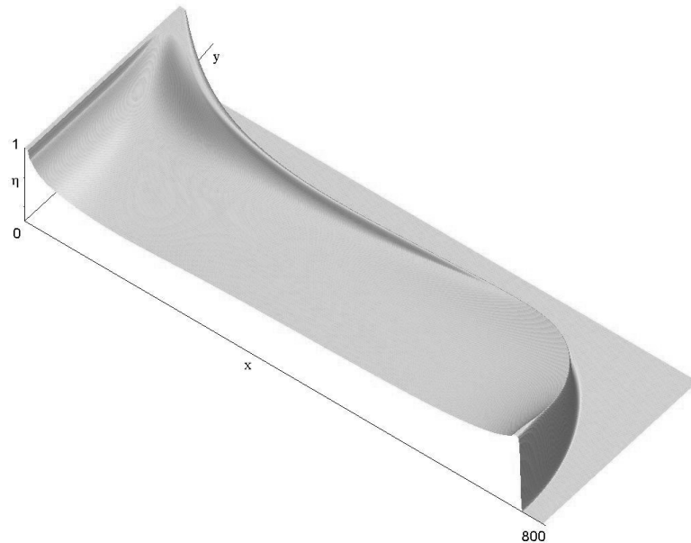
Рис. 1. Профиль глубины превращения в момент достижения волной горения открытого торца.
