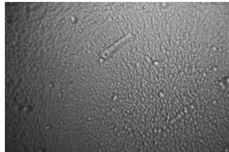
Рис. 3. Микроструктура полированной поверхности стеклокерамики Zerodur (Schott AG, Germany) после ее травления (x600).
