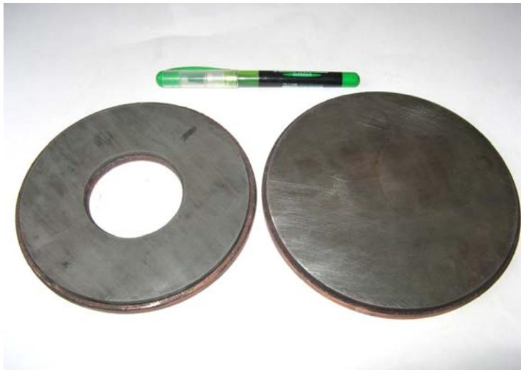
*Рис. 4. Внешний вид мишеней для магнетронного распыления*
