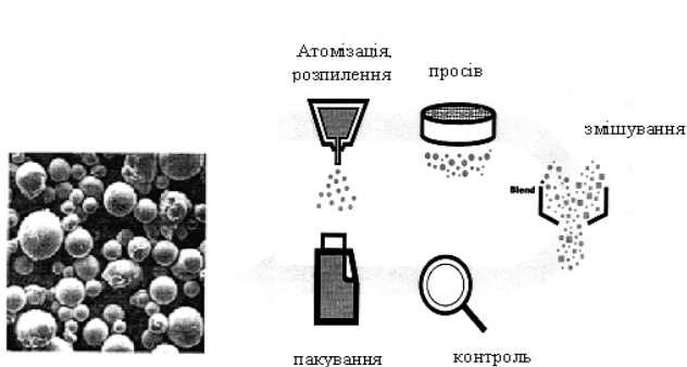
Рис. 4. Технологічна схема одержання порошку складнолегованого сплаву на основі кобальту виробництва фірми SulzerMetco
