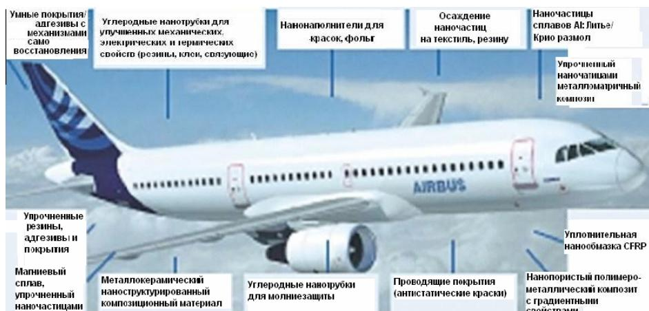
Рис. 4. Использование наноматериалов в авиации
