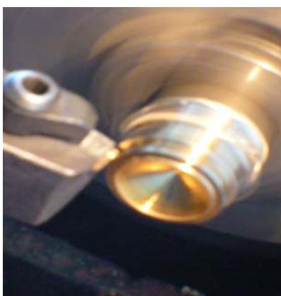
Рис. 3. Різання бронзи нанокомпозиційним різцем
