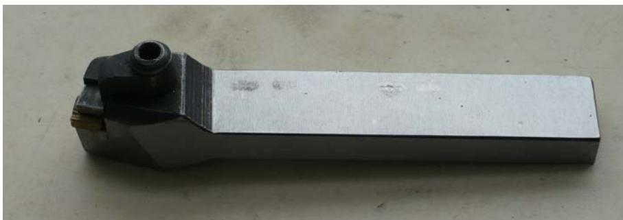
Рис. 3. Загальний вигляд різця з нанокерамічною вставкою
