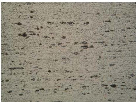
Рис. 3. Микроструктура сплава АМг6 без применения ЭДО,  $\times 500$
